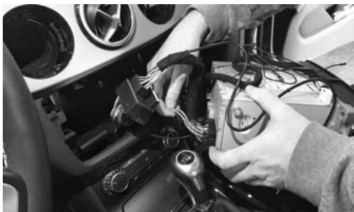
Collegare il cablaggio originale dell'auto a quello del dispositivo. Connect the original cable of the car to the positive one.
