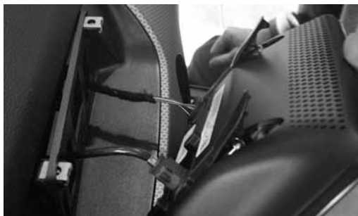
Scogliere e rimuovere il monitor originale. Disconnect and remove the original monitor.
