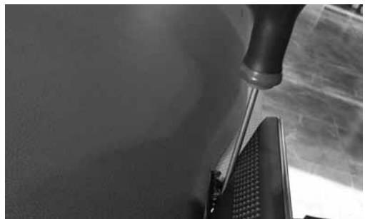
Sganciare le protezioni delle viti nel retro del monitor originale. Svitare le viti con (torx 20). Take away the screw protections on the back of the monitor.
