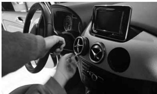
Smontare le bocchette d'aria centrali, destra e sinistra. Dismount the central ventilatio outlets, left and right.
